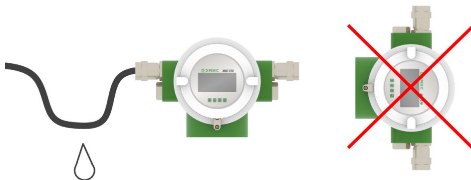
Рисунок 2.8 - Рекомендации по расположению кабелей и кабельных вводов
